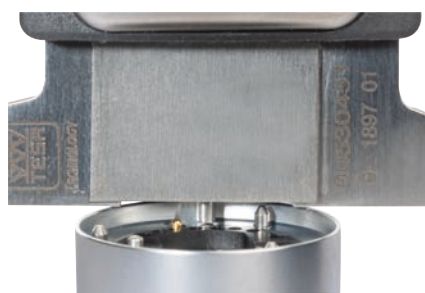
Messung mit Tiefenmessstab
