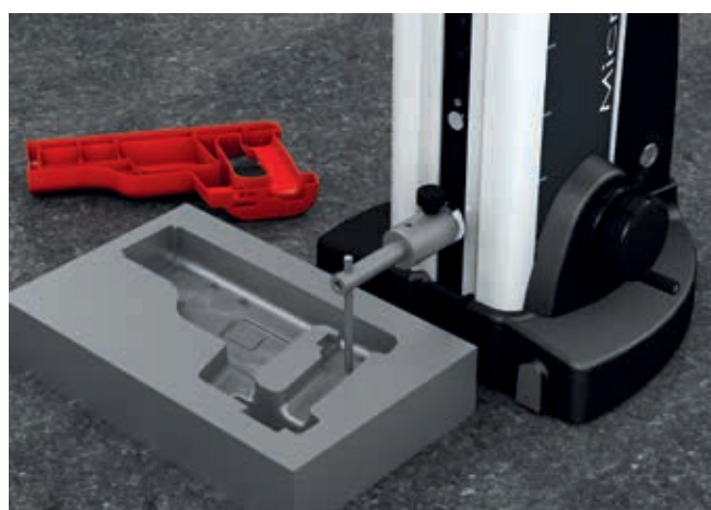
Mesure d'un moule d'injection pour carrosserie plastique d'une perceuse
