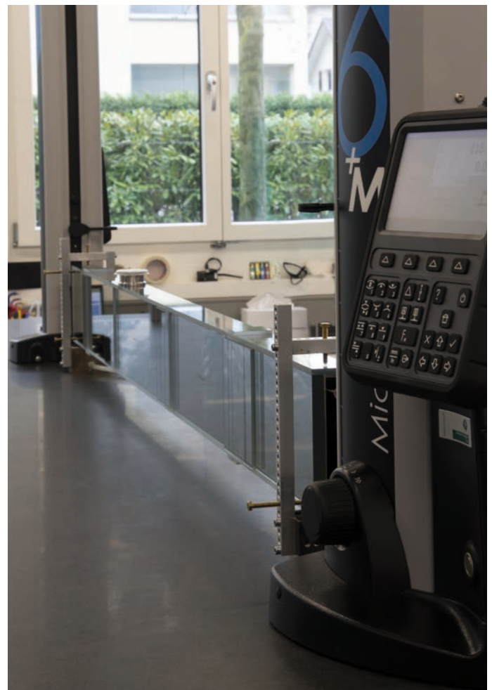
Die TESA MICRO-HITES werden am Eingang und Ausgang des Leiters verwendet und messen jeweils unterschiedliche Eigenschaften
