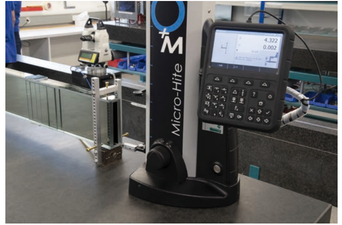
Das komplette System zur Rechtwinkligkeitsmessung
