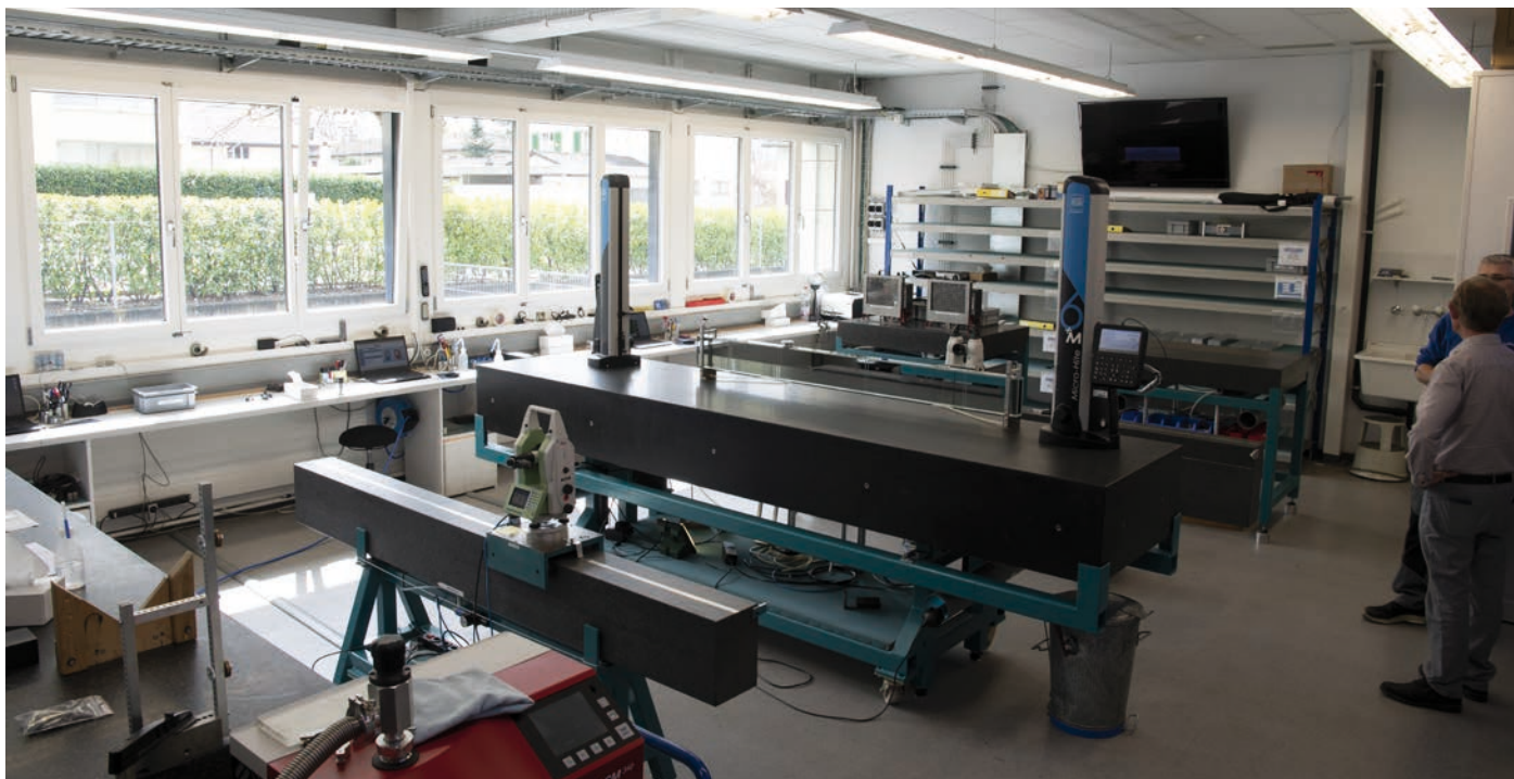
Die Montagezelle der Leiter verwendet zwei motorisierte TESA MICRO-HITEs, um sicherzustellen, dass die verschiedenen Untergruppen gut aufeinander abgestimmt sind
