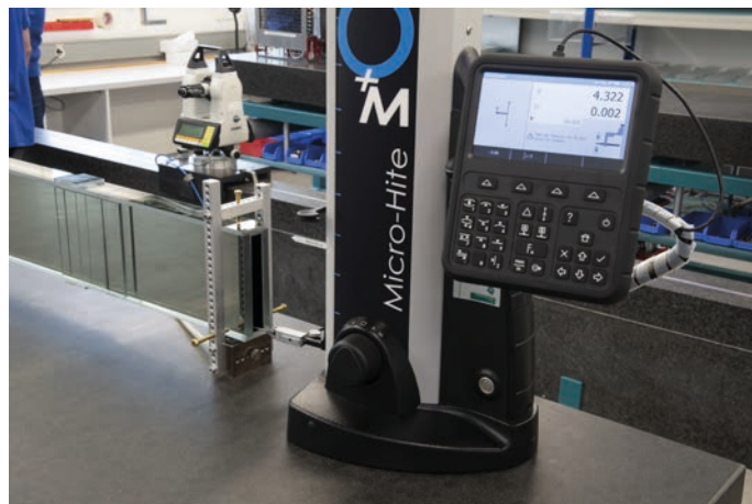
El sistema completo para la medición de perpendicularidad
