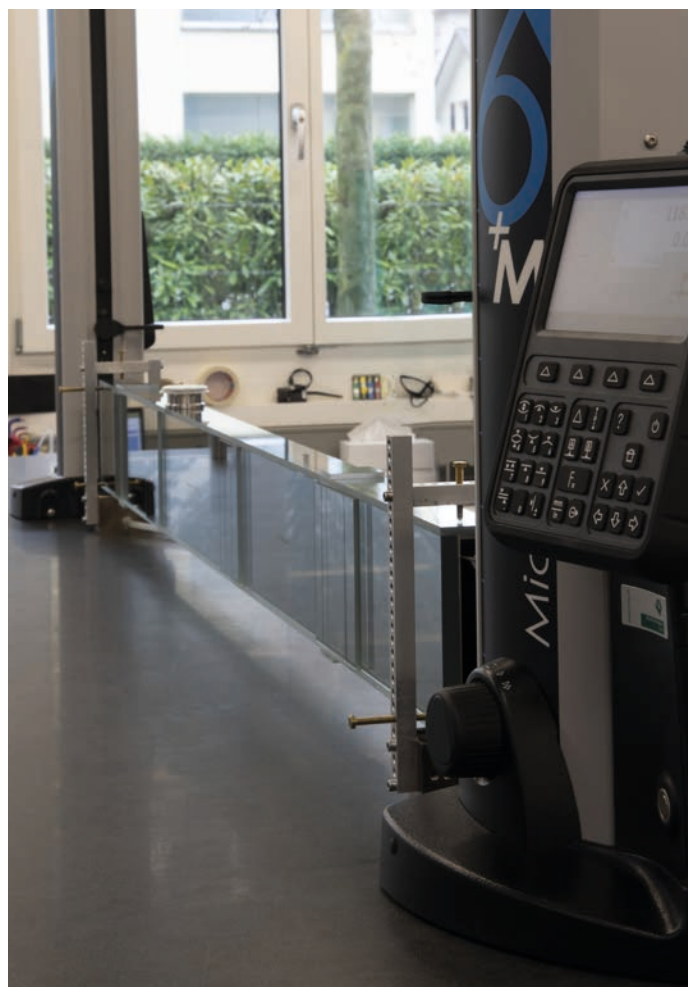
Los TESA MICRO-HITE se utilizan a ambos lados de la guía y miden cada uno características diferentes.
