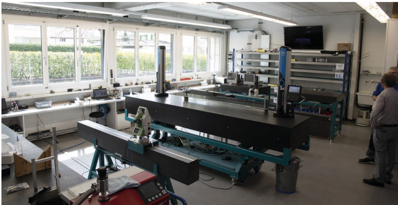
La célula de montaje de las guías utiliza dos TESA MICRO-HITE motorizadas para asegurar el buen emparejamiento de los subgrupos entre ellos.
