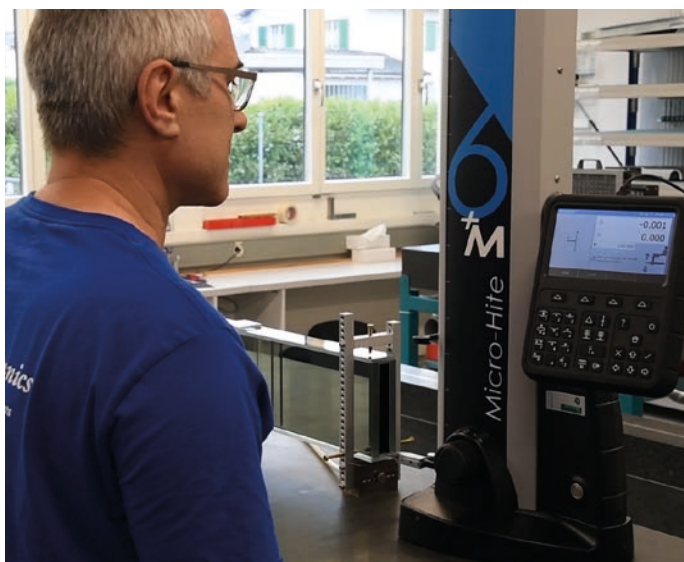
Brisacher en plena medida de perpendicularidad.
