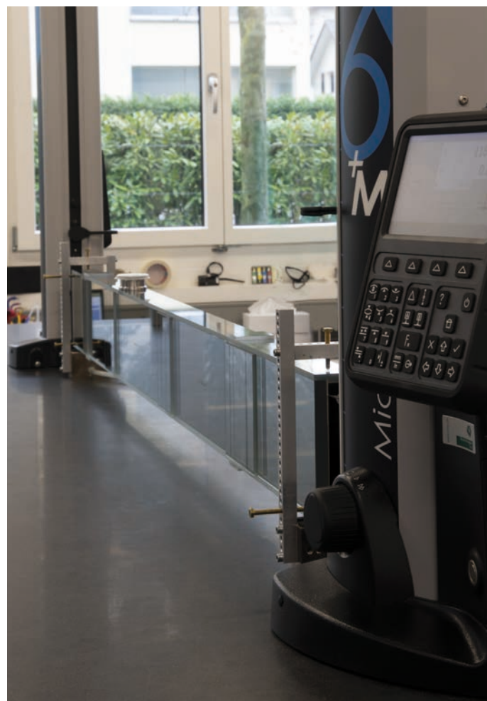
Les TESA MICRO-HITEs sont utilisés de chaque côté du guide et mesurent chacun des caractéristiques différentes.
