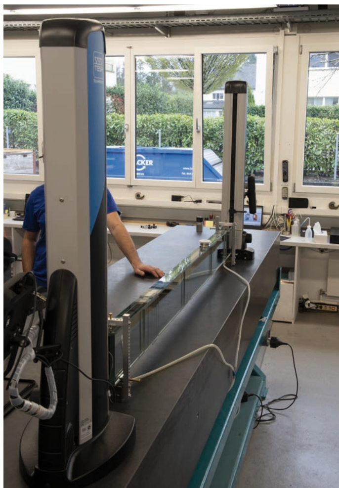
Les TESA MICRO-HITEs sont utilisés de chaque côté du guide et mesurent chacun des caractéristiques différentes.
