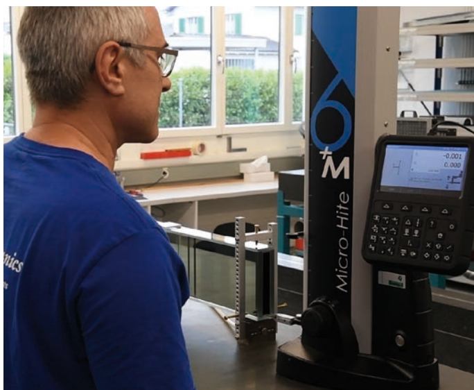
M. Brisacher en pleine mesure de perpendicularité.
