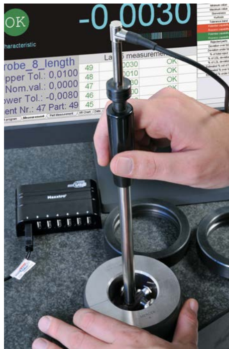
Vergleichsmessung eines Innendurchmessers mit einem USB-Messtaster, VERIBOR und einem Einstellring
