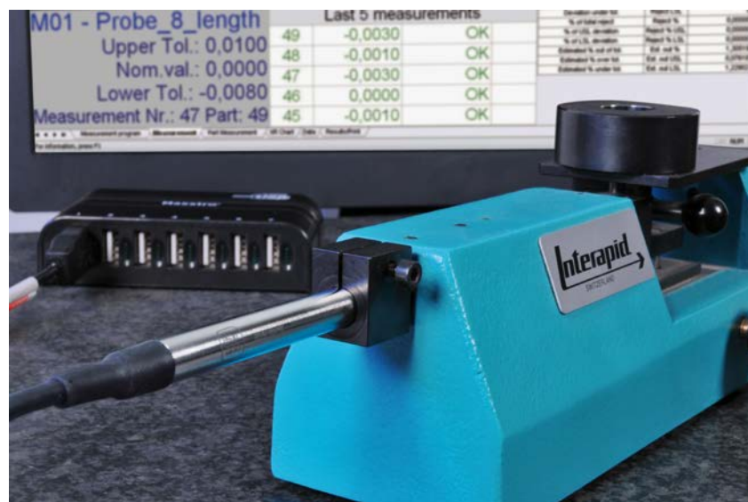
Utilizzo di un tastatore USB con un banco di misura INTERAPID SHE
