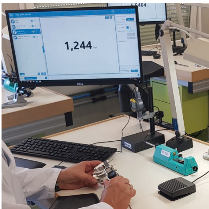
Drahtlos mit der Software TESA DATA-VIEWER verbundene Instrumente
