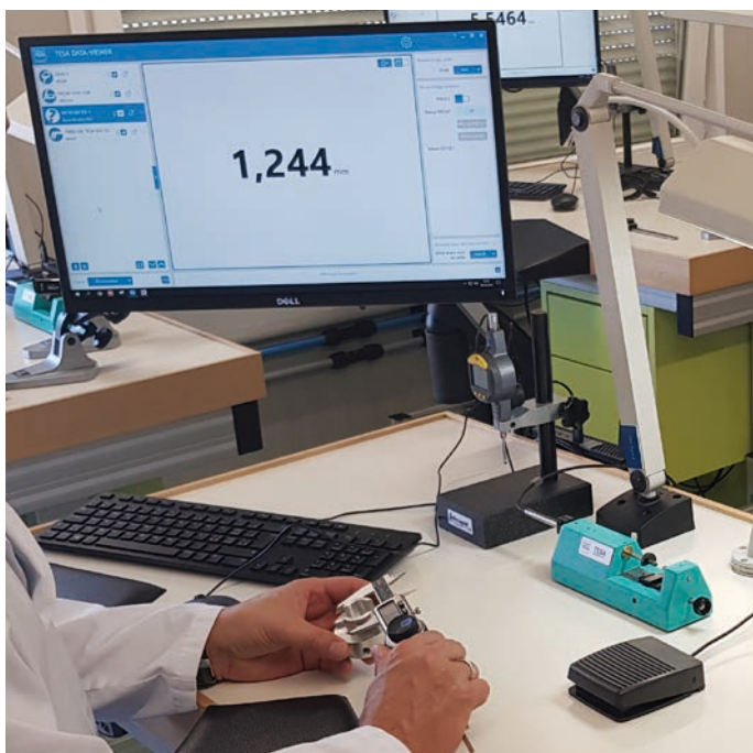
Instruments connectés sans fil au logiciel TESA DATA-VIEWER
