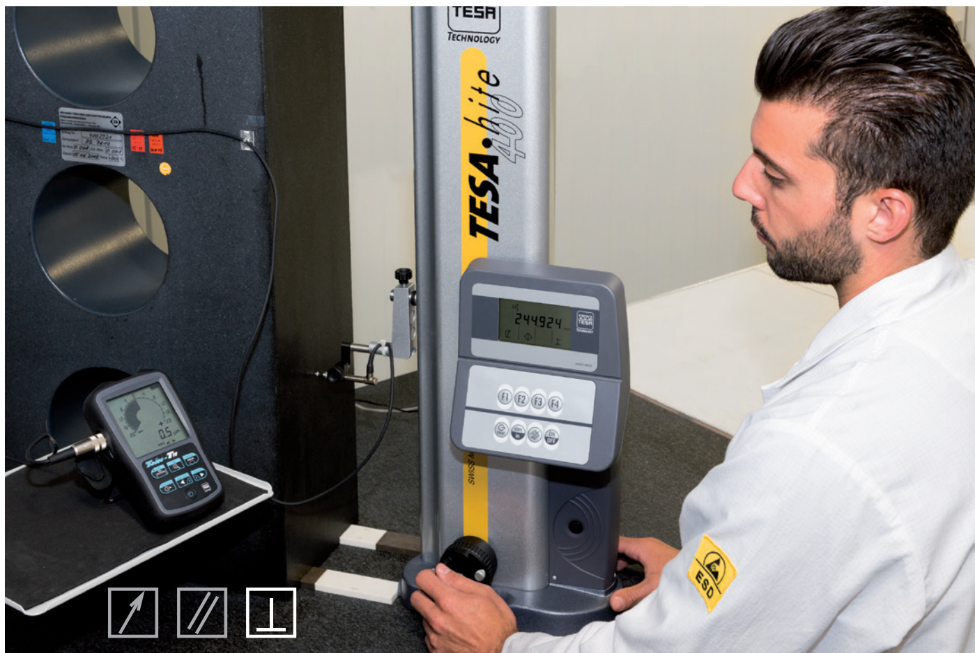
Verifica della perpendicolarità dell'asse verticale contro una squadra in granito
