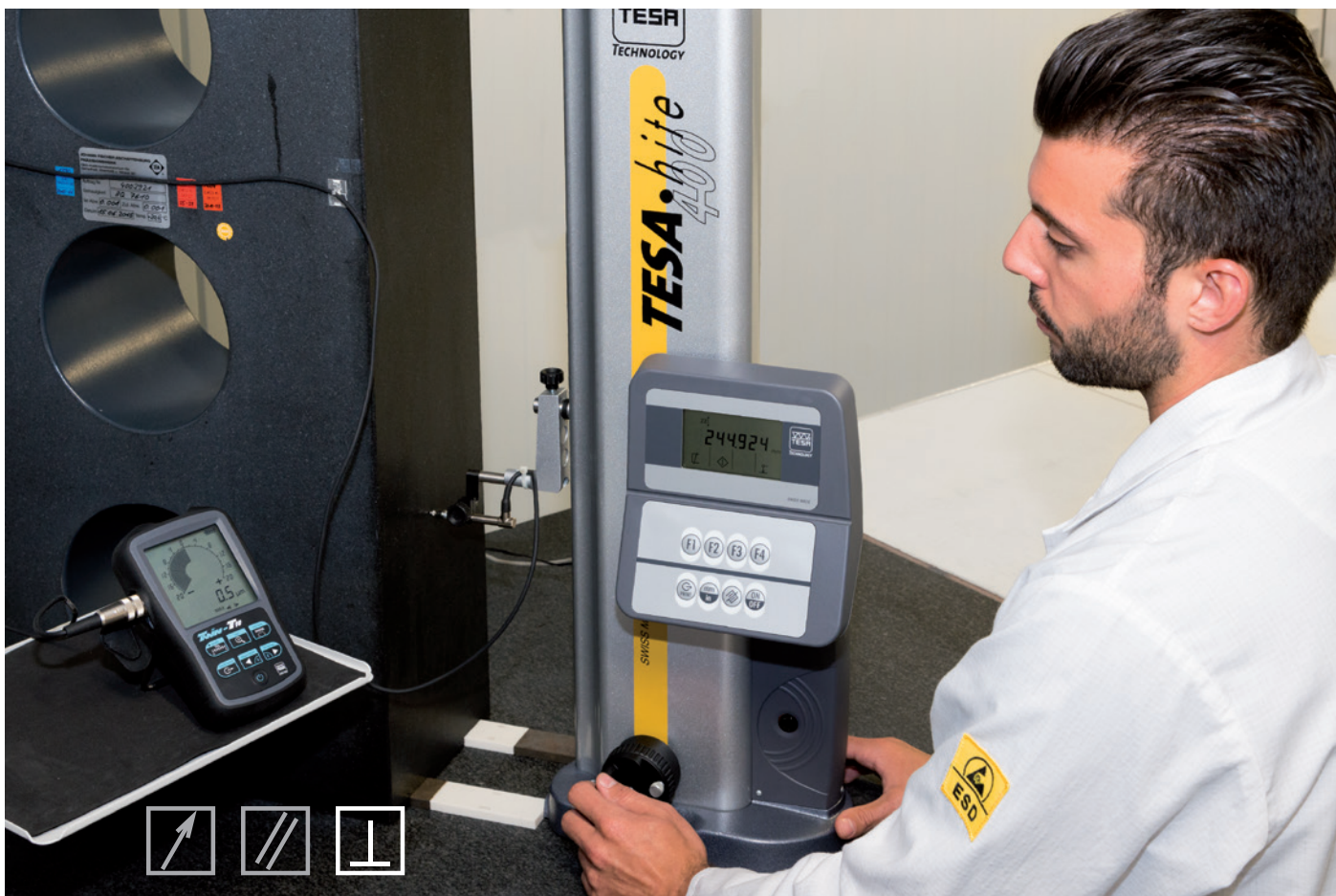
Verificación de la perpendicularidad del eje vertical contra una escuadra de granito
