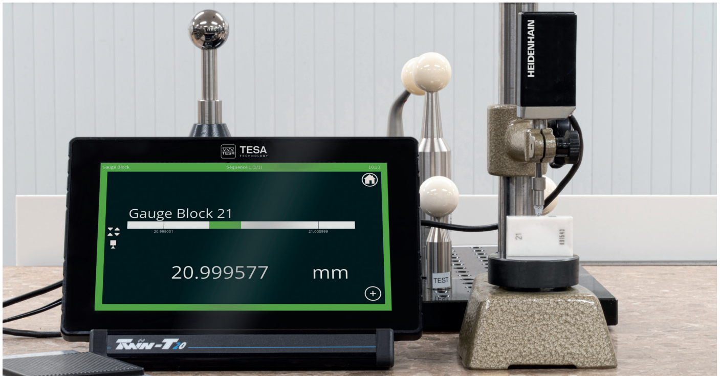
Controllo di un blocchetto di riscontro in ceramica
