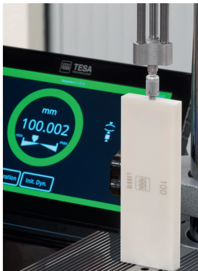
Controllo di un blocchetto di riscontro in ceramica
