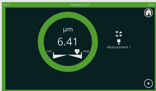
Visualización tipo «Indicadores circulares», una cota
