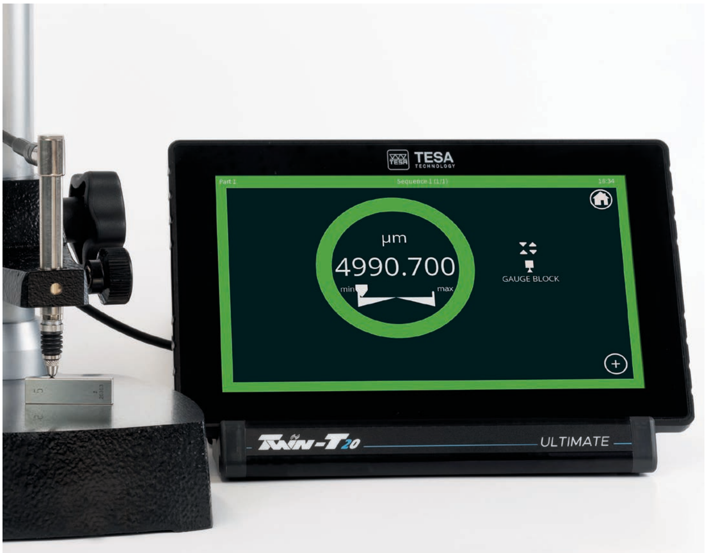
Mesure d'une cale sur un marbre rectifié avec un affichage au 0,001 µm du palpeur inductif connecté
