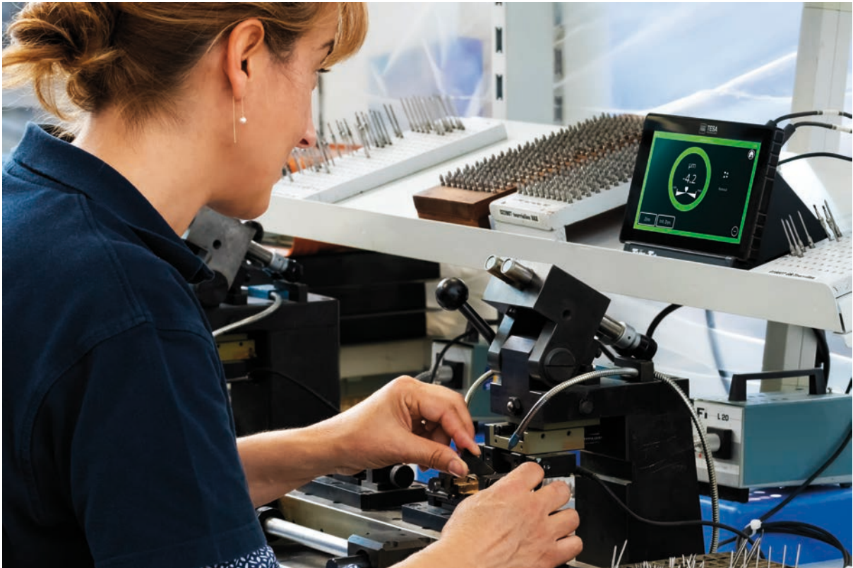
Medida de la concentricidad antes del montaje de piezas cilíndricas
