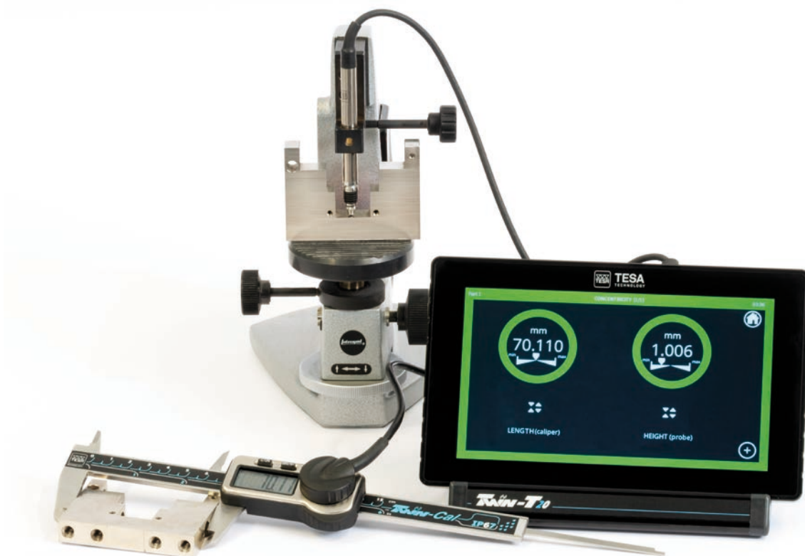
Control de 2 cotas funcionales, una con una sonda inductiva TESA y la otra con un pie de rey conectado al visualizador
