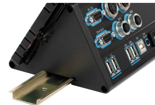
Les lames ressort installées dans le profil de l'afficheur permettent la fixation de l'appareil sur rail DIN 35x7,5 mm
