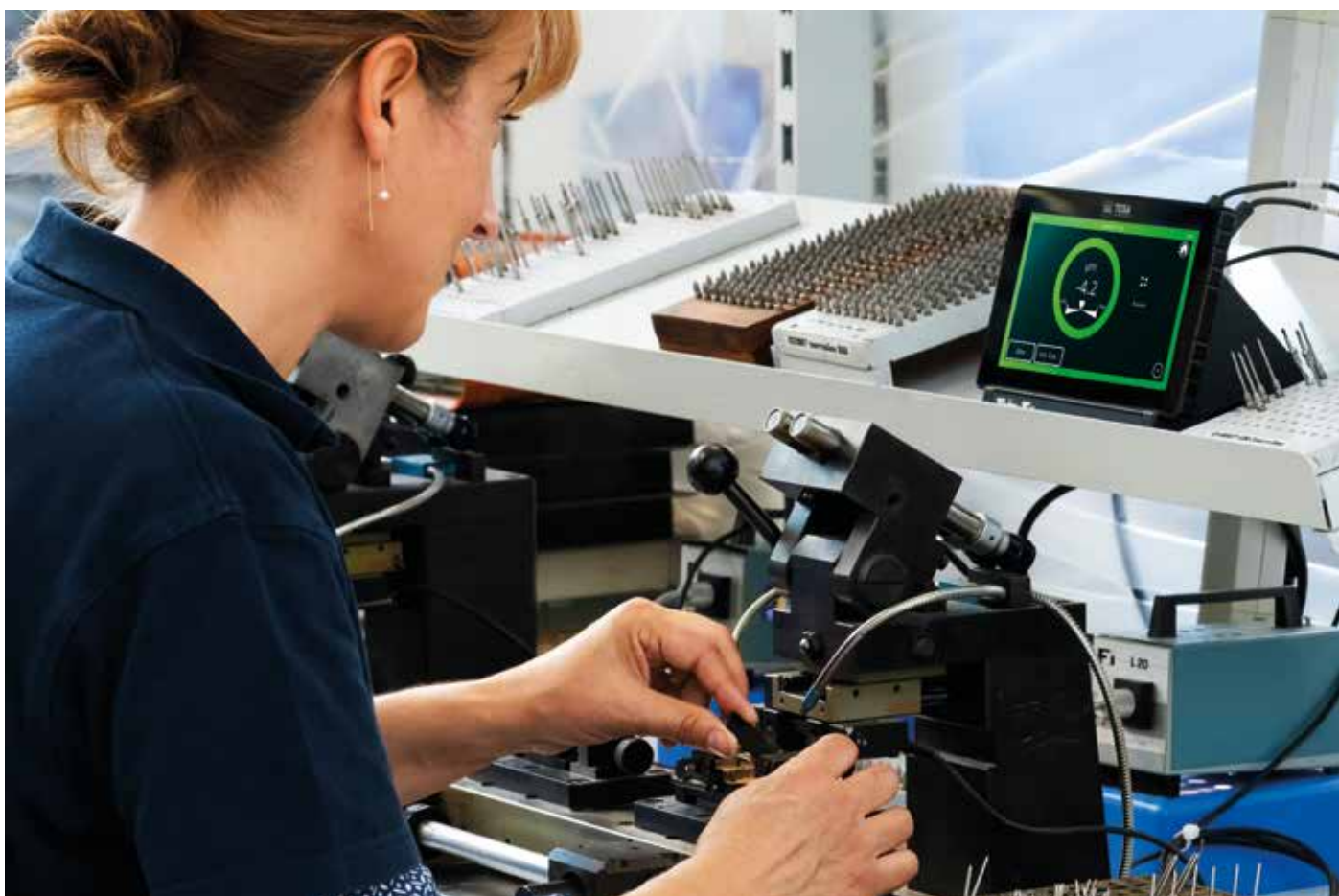
Misura della concentricità prima dell'assemblaggio di pezzi cilindrici.
