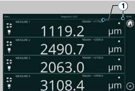
Visualizador de tipo «Indicadores numéricos», cuatro cotas
