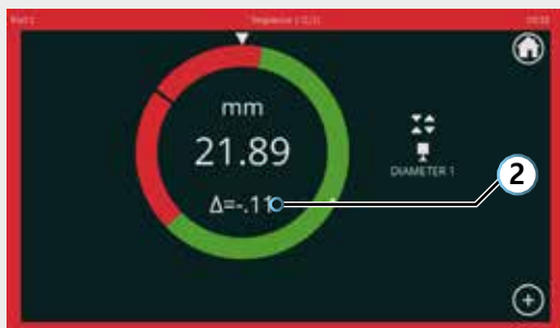
Visualizador de tipo «Indicadores giratorios», una cota
