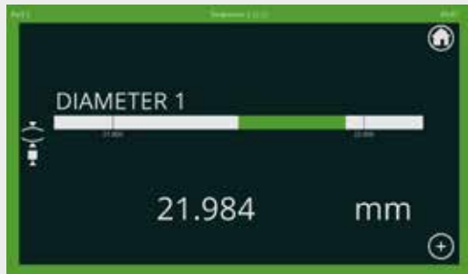
Visualizador de tipo «Indicadores de gráficos de barras», una cota
