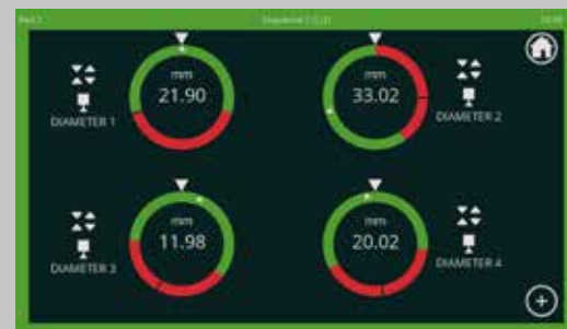
Visualizador de tipo «Indicadores giratorios», cuatro cotas
