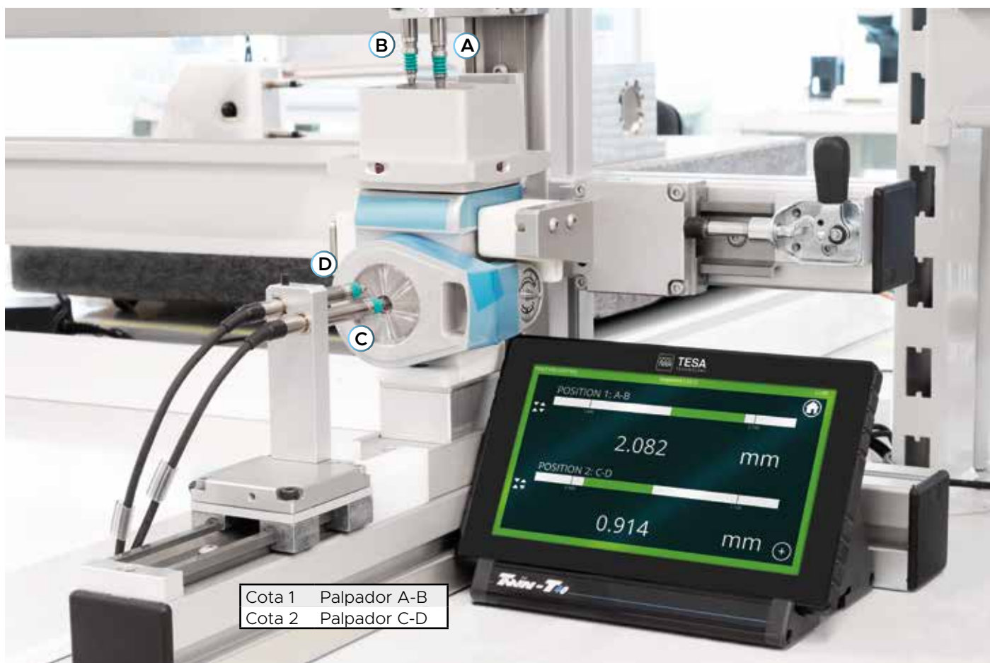
Control de la posición durante una operación de montaje
