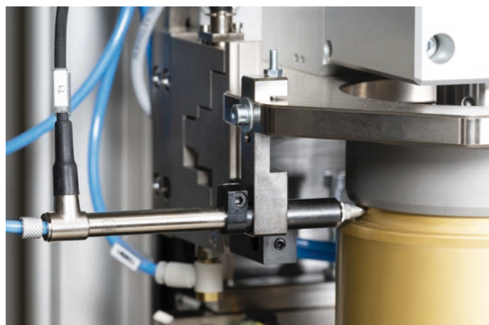
Mesure avec palpeur à pression pneumatique
