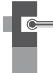
Kalibrieren mit der Nut des Endmaßes
