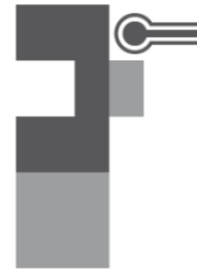
Kalibrieren mit dem Zapfen des Endmaßes
