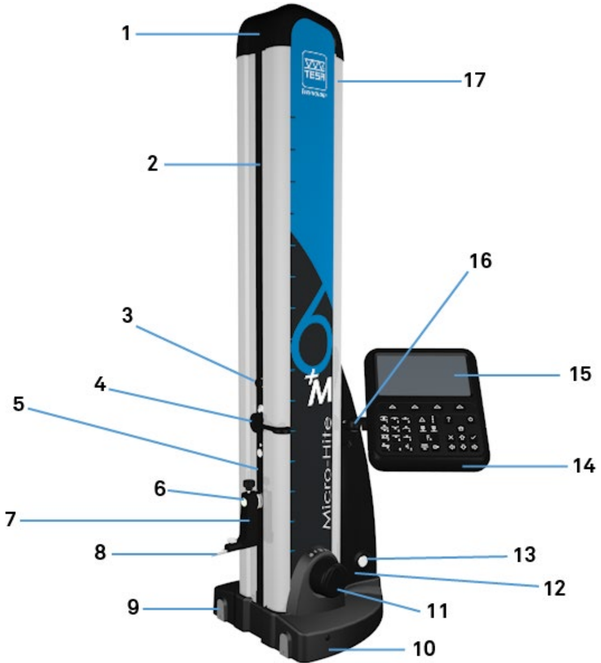
Fig. Descripción de los elementos que conforman la columna TESA MICRO-HITE+M
