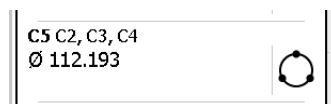
Cercle défini par trois points Bloc à une seule valeur (diamètre du cercle)
