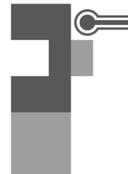
Etalonnage via le tenon de la jauge
