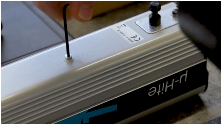
15. Monter la tête de palpation sur le support.
