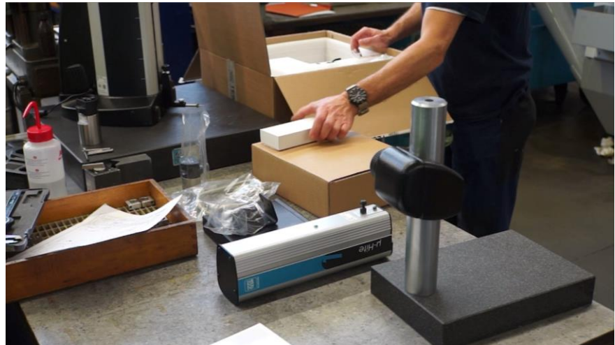
14. Dévisser la vis à l'arrière de la tête de palpation. Celle-ci est utilisée pour bloquer le système lors de son transport.
