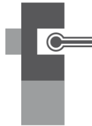
Kalibrieren mit der Nut des Endmaßes
