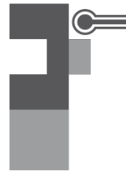
Kalibrieren mit dem Zapfen des Endmaßes
