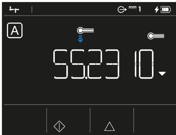
Resultado de la medición obtenido a partir de un palpado hacia abajo en el modo ST1
