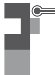
Calibración mediante la espiga del patrón
