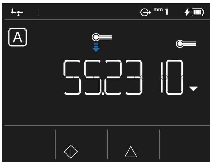
Résultat de mesure issu d'un palpage vers le bas en mode ST1
